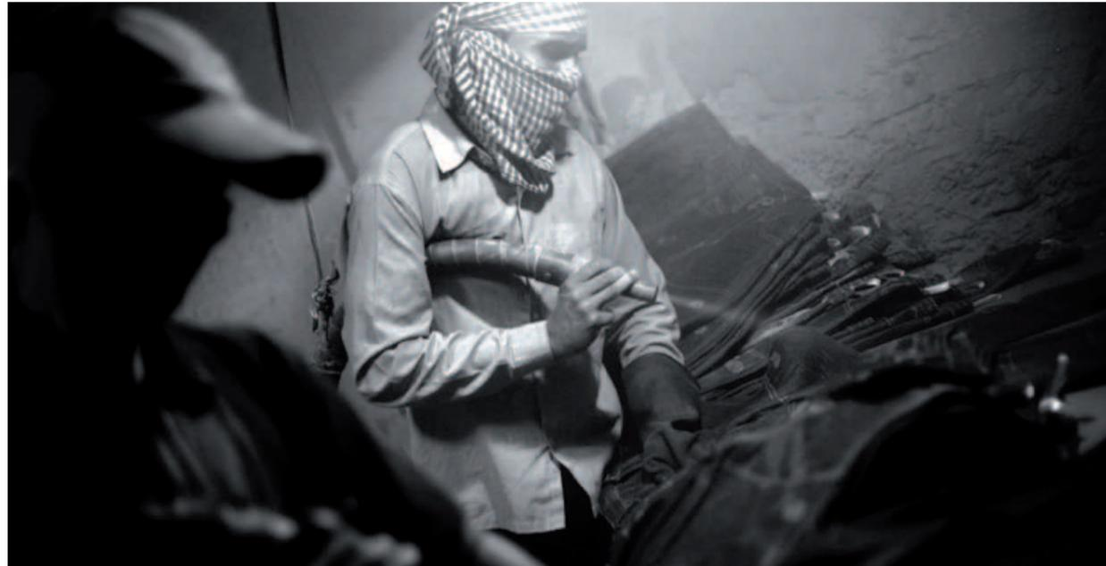
Sabler un jeans consiste à retirer la pigmentation indigo du tissu (denim) en propulsant à forte pression un jet de matière abrasive, en l'occurrence du sable. Cela assouplit et éclaircit le denim. La technique est identique au sablage d'une façade. A l'énorme différence près que le sablage de jeans est réalisé dans un endroit confiné, sans ventilation adéquate, et que le travailleur sable à longueur de journée et de semaine sans moyens de protection fiables.
